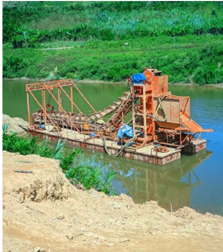
Les équipements d'extraction aurifère installés dans la localité d'Anosy. Crédit photo : M.R et T.N
